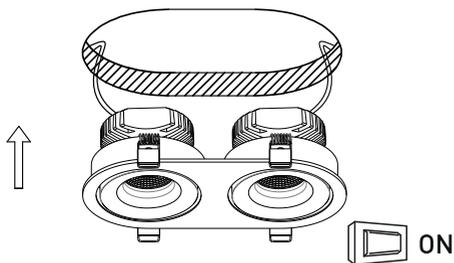
Пружинные ушки надежно зафиксируют светильник в отверстии. Теперь можно включить питание светильника.
