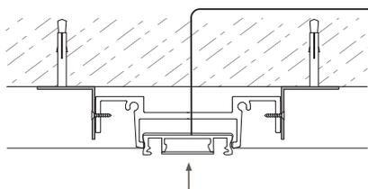
5. Закрепите шинопровод в профиле-держателе
