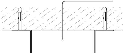
2. Закрепите профиль-держатель на монтажных уголках, предусмотрев отверстие для ввода питания
