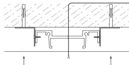
4. Подключите шинопровод к сети и установите в профиль-держатель не разрезая полотна натяжного потолка
