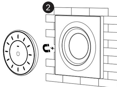
2. Приклейте и хорошо прижмите базу к предварительно очищенной и обезжиренной поверхности. Пульт крепится к базе на магнитах
