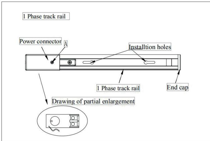
Однофазный шинопровод с подводом питания и заглушкой в комплекте.
