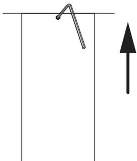
3. Подключите светильник и установите его на крепление, повернув по часовой стрелке и зафиксировав шестигранным винтом.
