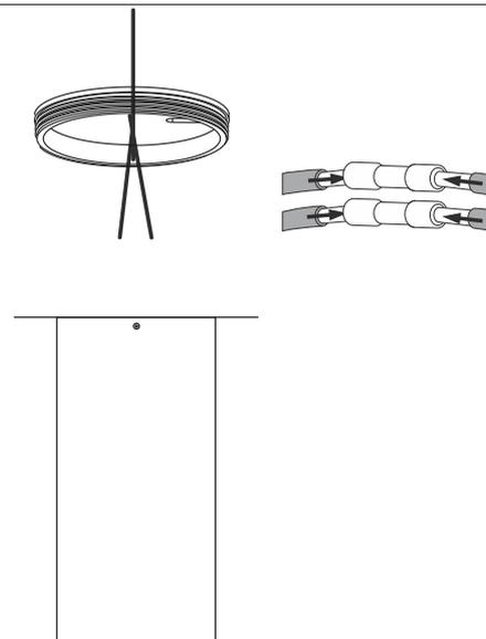
2. Отключите сетевое напряжение. Подключите светильник к проводам сети питания.
