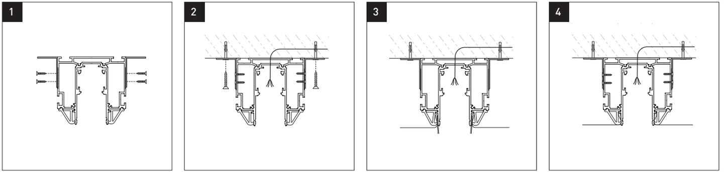
1. В треке предварительно подготовьте отверстие для ввода провода питания. Зафиксируйте по бокам трека металлические монтажные уголки.
