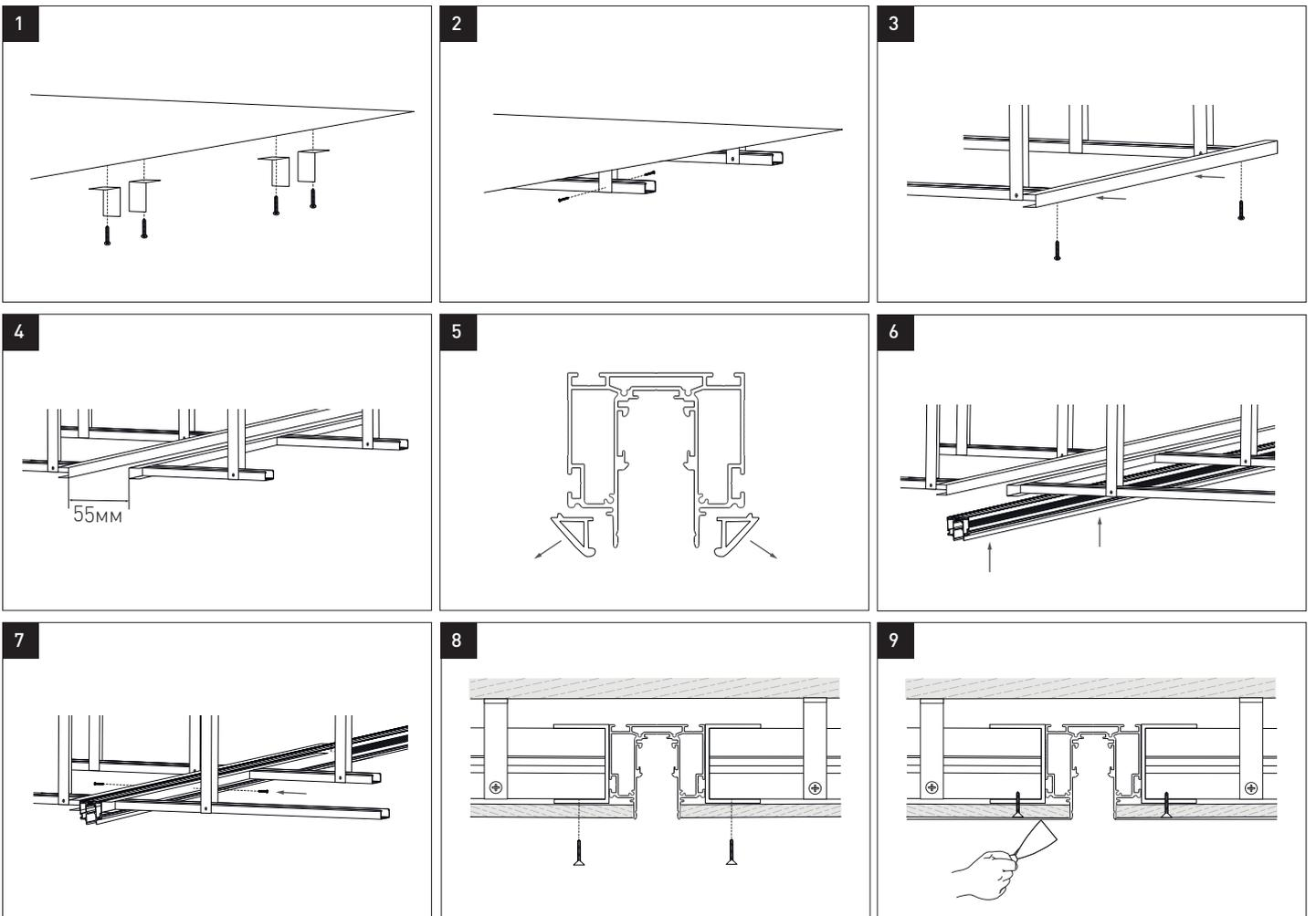
1. Установите и зафиксируйте на потолке монтажные уголки
