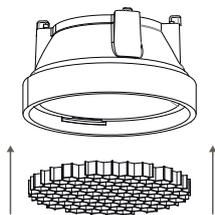
2. Зафиксируйте линзу на светодиодном модуле
