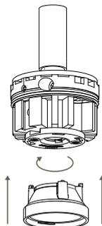
3. Зафиксируйте накладку на модуле с линзой
