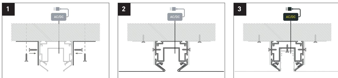
1. Используя кронштейны или подвесы, закрепите профиль на поверхности чернового потолка. Подведите провод питания.
