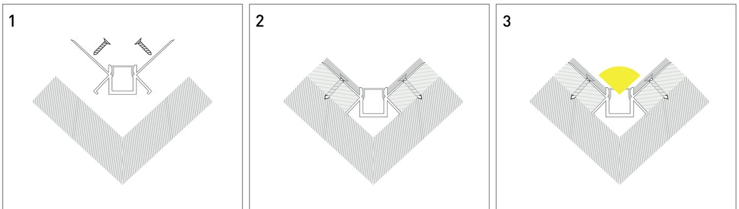
1. Установите профиль в угол стены, подсуньте под полки профиля листы гипсокартона, зафиксируйте саморезами.
