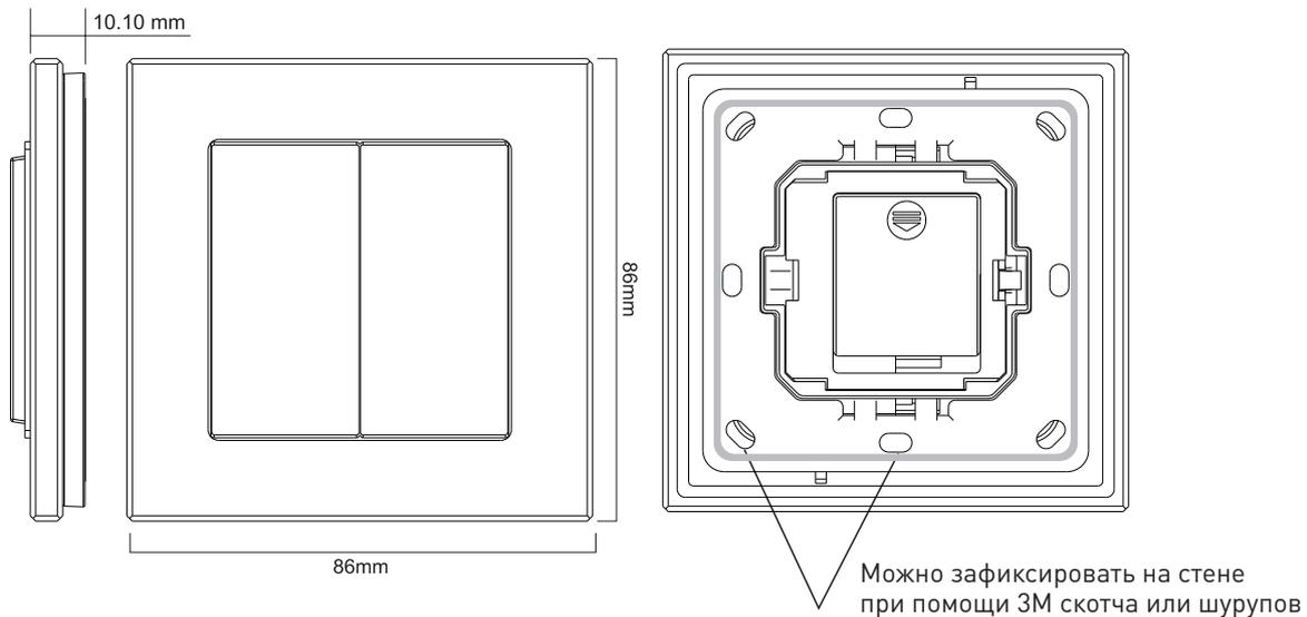
Беспроводной клавишный выключатель системы EasyBus, функции верхней и нижней части каждой кнопки можно гибко настраивать через приложение EasyThings. Каждой кнопке можно присвоить возможность вкл/выкл, менять яркость, цвет или цветовую температуру, сохранять и запускать сцены и сценарии освещения. Передача команд исполнительным устройствам производится при помощи радиосигнала.
