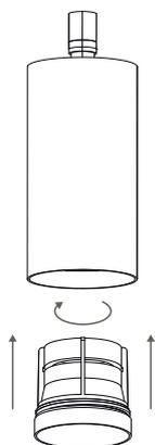
5. Установите выбранный адаптер, поворачивая втулку на ножке светильника
