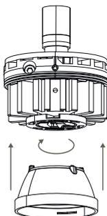
3. Зафиксируйте накладку на модуле с линзой
