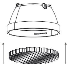
2. Зафиксируйте линзу на светодиодном модуле
